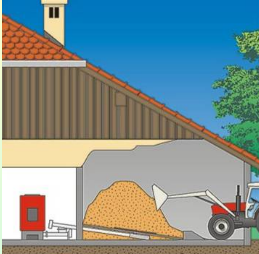
Stoccaggio aziendale vicino alla sala di riscaldamento
