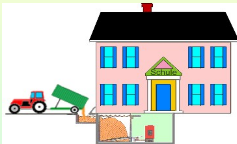
Fornitura di calore per un edificio singolo
